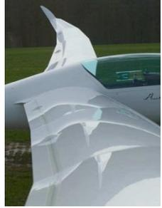
Wölbklappen ermöglichen es, das Flügelprofil an den benötigten Auftrieb anzupassen:
