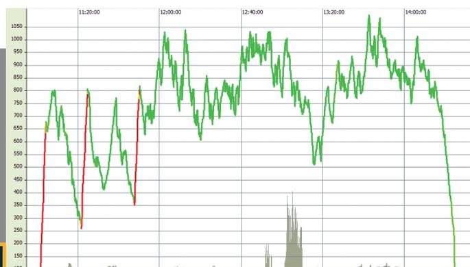
*Das Barogramm eines Bundesligafluges eines Motorseglerpiloten, der sich zwar an alle bestehenden Regeln hält, aber wo jeder Segelflieger bei dem ersten Absauser auf einem Feld gelandet wäre und keine zweite Chance für die Bundesliga gehabt hätte.*
